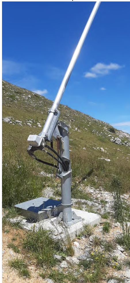
Le lance installate sulla pista della Selletta ad Artesina
