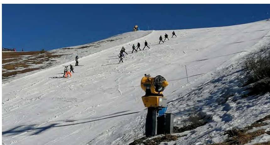
I generatori fissi su torre lungo la pista del Colletto
